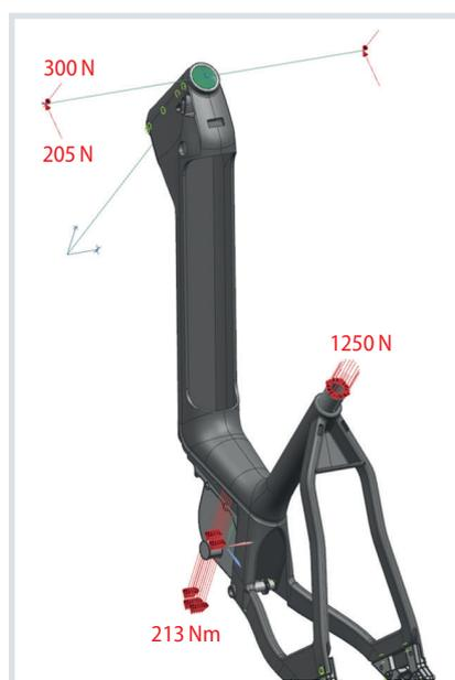
**Bild 3.** Unterschiedliche Belastungen, die auf den Fahrradrahmen wirken, ergänzen sich zum Lastfall. © Habilitationsschrift U. Cakmak
